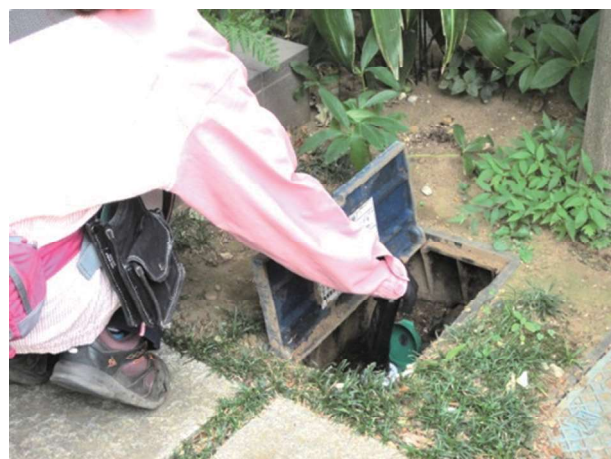
時間積分式漏水発見器による調査作業 (水道使用量検針時に漏水の有無を調べます。)
